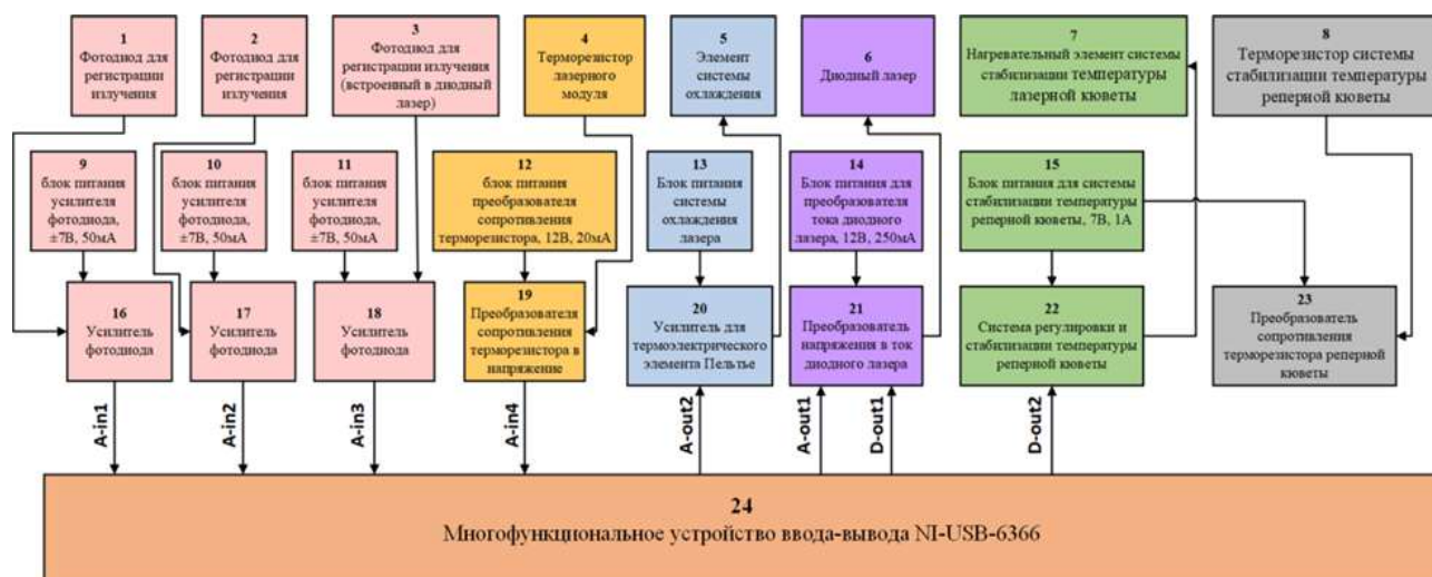
Рисунок 1. Структурная схема TDLAS-газоанализатора
