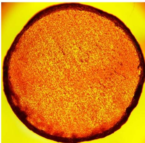
Рисунок 2. Структура ЖИГ-ГГГ в микроскопе «Микромед 3 вар. 3-20»
