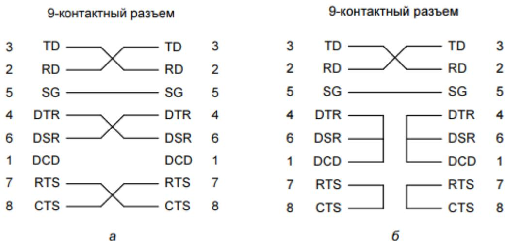
Рисунок 3. Нуль-модемное соединение: а – полнофункциональное соединение, б – упрощенный вариант
