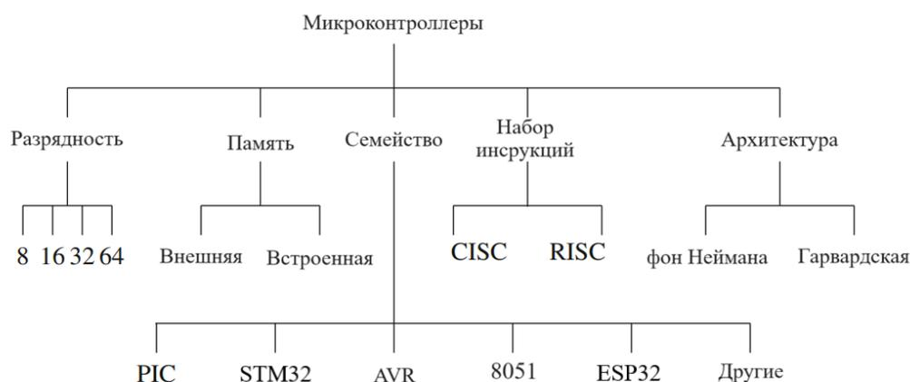
Рисунок 3. Классификация микроконтроллеров
