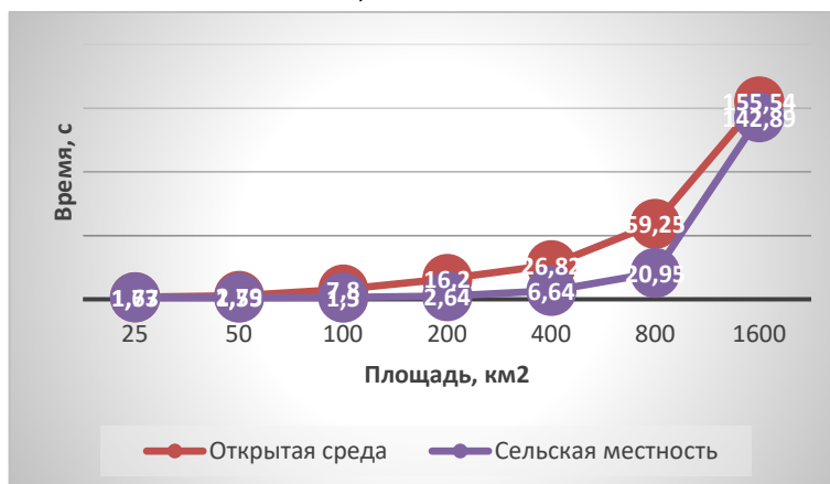
Рисунок 8. Зависимость времени расчета размещения БС от площади территории при высотах антенн h_{BC}=50\text{м} и h_{PC}=1,5\text{м}
