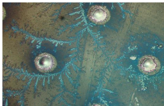
Рисунок 15. Примеры следов с выпуклым фронтом. Фото, 50X. Эксперимент, монокристалл 4H-SiC<N> грань (0001)Si, силиконовое масло, мощность ЛИ P=3,5 Вт
