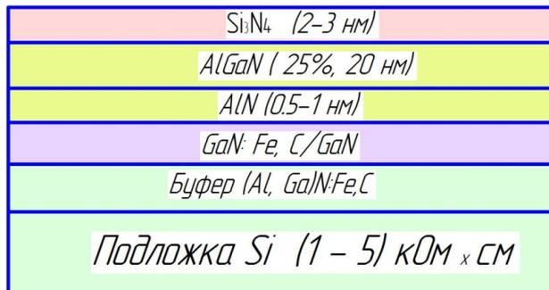
Рис.2. Схематичное изображение экспериментальной гетероструктуры AlGaN/AlN/GaN
