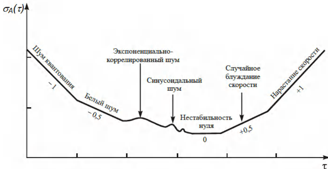
Рисунок 2. Общий вид кривой Аллана с характерными наклонами
