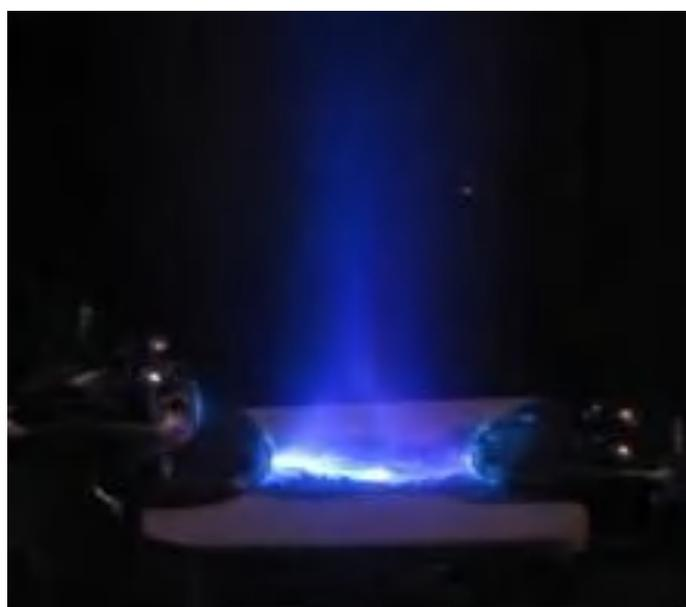
Рисунок 5. Дендритная структура разряда по поверхности сегнетокерамики
