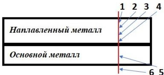
Рисунок 1. Схема проведения металлографических исследований: 1 – верхняя часть наплавленного металла; 2 – средняя часть наплавленного металла; 3 – нижняя часть наплавленного металла; 4 – зона сплавления валика и основного металла; 5 – основной металл; 6 – линия измерения микротвердости
