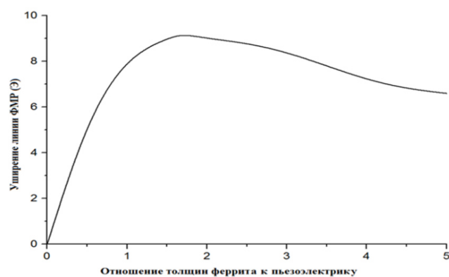
Рисунок 6. Зависимость уширения линии ФМР от отношения толщины ЖИГ и двух слоев ЦТС с противоположными направлениями поляризации
