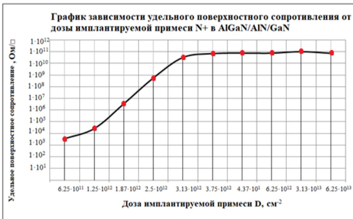
Рисунок 6. График зависимости удельного поверхностного сопротивления от дозы имплантируемой примеси N+ в AlGaN/AlN/GaN
