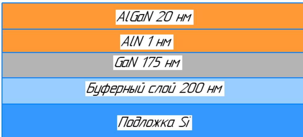
Рисунок 2. Схематичное изображение экспериментальной гетероструктуры AlGaIn/AlN/GaN
