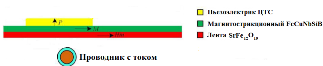
Рисунок 4. МЭ композит \text{SrFe}_{12}\text{O}_{19}/\text{FeCuNbSiB}/\text{PZT}
