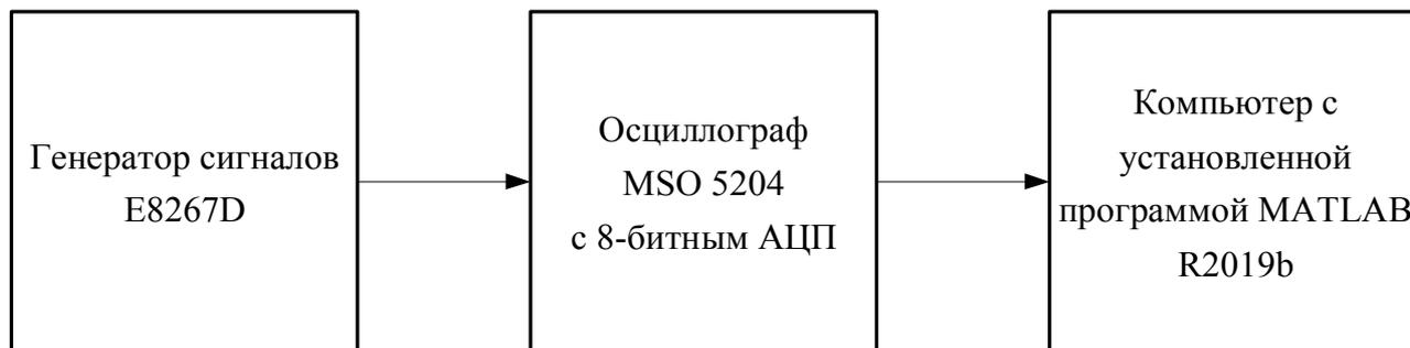
Рис.2. Структурная схема стенда формирования и обработки ФМС
