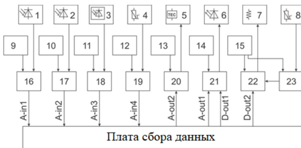
Рисунок 1. Структурная схема электронной части устройства
